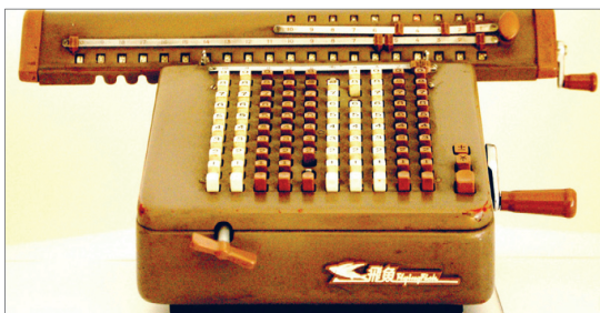
Sumator (maszyna licząca do dziesięciu miejsc po przecinku).
